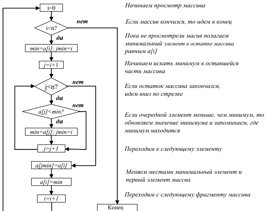
Рис. 1.3: Пример блок-схемы для наивной сортировки массива.
